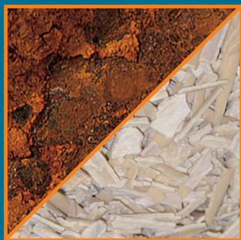
Le soluzioni minerali JUDO JUL consentono di arrestare il processo di corrosione. A seconda del tipo di materiale del tubo, diverse combinazioni di minerali vengono iniettate nella rete idrica attraverso il sistema di dosaggio JULIA per formare un film protettivo altamente efficiente all'interno dei tubi. Altre soluzioni JUDO JUL possono essere dosate per stabilizzare la durezza disciolta, evitando incrostazioni nei tubi e negli accessori.
