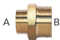
Nipplo ridotti M/M in ottone con doppia filettatura maschio ISO 228 G a battuta piana (A-B) Brass M/M reduced nipples with double ISO 228 G male thread with plane end (A-B)
