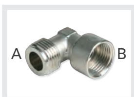
Gomito 90° M/F in ottone nichelato con filettatura maschio ISO 228 G a battuta piana (A) e filettatura femmina ISO 228 G (B)
