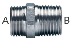
Nipplo M/M in ottone nichelato con filettatura maschio ISO 228 G a battuta piana (A) e filettatura maschio conica EN 10226 R (B)
