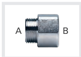
Nipplo M/F in ottone nichelato con filettatura maschio ISO 228 G a battuta piana (A) e filettatura femmina EN 10226 Rp (B)
