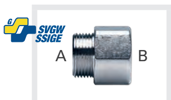
Nipplo M/F in ottone nichelato con filettatura maschio ISO 228 G a battuta piana (A) e filettatura femmina EN 10226 Rp (B)
