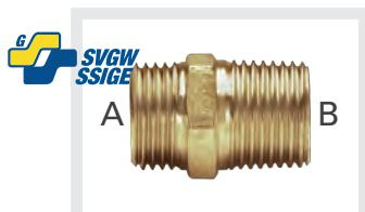
Nipplo M/M in ottone con filettatura maschio ISO 228 G a battuta piana (A) e filettatura maschio conica EN 10226 R (B)
