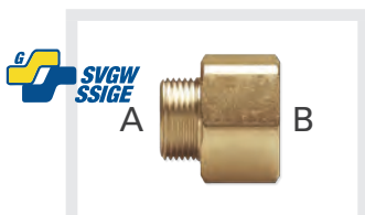
Nipplo ridotti M/F in ottone con filettatura maschio ISO 228 G a battuta piana (A) e filettatura femmina EN 10226 Rp (B)
