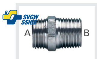
Nipplo M/M in ottone nichelato con filettatura maschio ISO 228 G a battuta piana (A) e filettatura maschio conica EN 10226 R (B)
