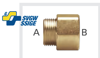
Nipplo M/F in ottone con filettatura maschio ISO 228 G a battuta piana (A) e filettatura femmina EN 10226 Rp (B)
