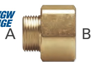
Niplo ridotti M/F in ottone con filettatura maschio ISO 228 G a battuta piana (A) e filettatura femmina EN 10226 Rp (B)
