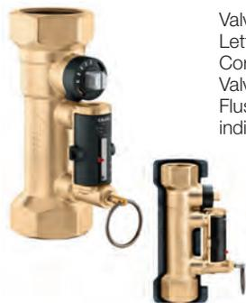
Valvola di bilanciamento con flussometro. Lettura diretta della portata. Corpo valvola e flussometro in ottone. Valvola a sfera per regolazione portata. Flussometro a scala graduata con indicatore portata a movimento magnetico.
