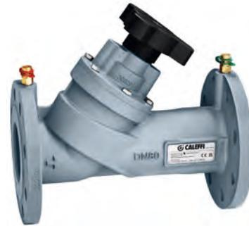
Valvola di bilanciamento per circuiti idraulici. Corpo: - DN 65–200: ghisa grigia - DN 250 e 300: ghisa sferoidale. Otturatore: - DN 65–200: tecnopolimero - DN 250 e 300: ghisa sferoidale. Completa di prese di pressione ad innesto. Pmax di esercizio: 16 bar. Campo di temperatura: DN 65–DN 300: -10–120 °C. Max percentuale di glicole: 50 %. Attacchi flangiati PN 16. Accoppiamento con controflangia EN 1092-1.
