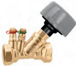
Valvola di bilanciamento per circuiti idraulici. Misura di portata con dispositivo Venturi. Corpo in lega antidezincificazione CR, otturatore in acciaio inox. Complete di prese di pressione ad innesto. Pmax di esercizio: 16 bar. Campo di temperatura: -20–120 °C. Max percentuale di glicole: 50 %.
