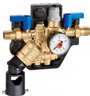
Per installazione orizzontale o verticale. Corpo in ottone. **Con coibentazione.** Campo di regolazione del gruppo di riempimento : 0,8-4 bar. Pmax di esercizio: 10 bar. Tmax di esercizio: 65 °C. Disconnettore a norma EN 12729. Riduttore di pressione a norma EN 1567. PATENT.
