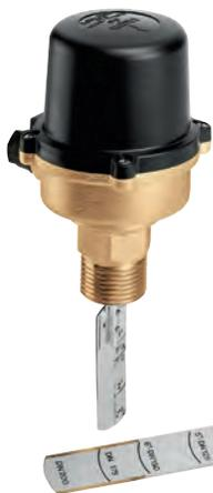
Flussostato. Per tubazioni da 1" a 8". 250 V (AC) - 15 (5) A. Pmax di esercizio: 10 bar. Campo di temperatura: -30-120 °C. Grado di protezione: IP 54.
